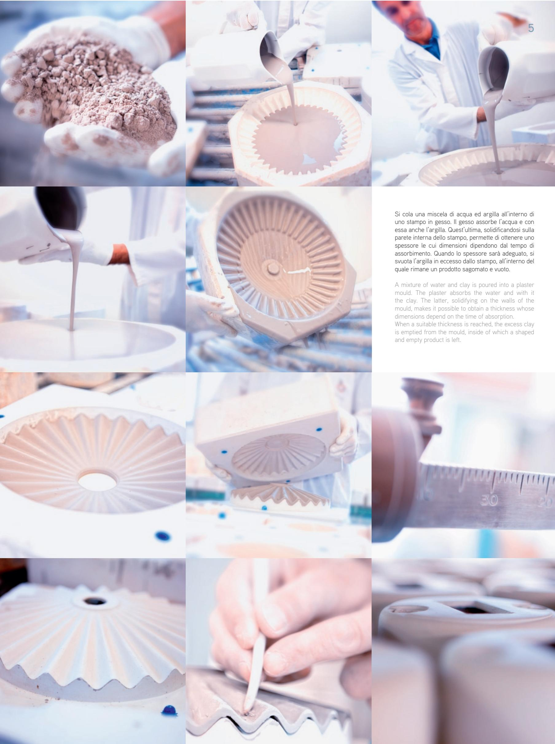
Sicola una miscela di acqua ed argilla all'interno di uno stampo in gesso. Il gesso assorbe l'acqua e con essa anche l'argilla. Quest'ultima, solidificandosi sulla parete interna dello stampo, permette di ottenere uno spessore le cui dimensioni dipendono dal tempo di assorbimento. Quando lo spessore sarà adeguato, si svuota l'argilla in eccesso dallo stampo, all'interno del quale rimane un prodotto sagomato e vuoto.
