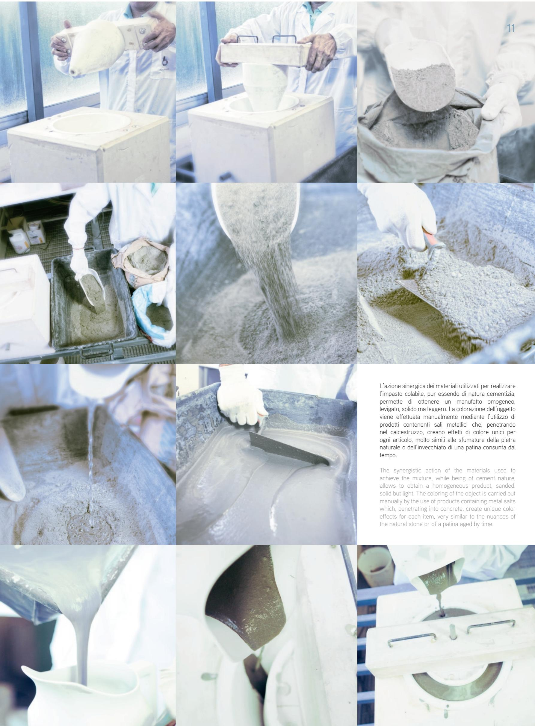
L'azione sinergica dei materiali utilizzati per realizzare l'impasto colabile, pur essendo di natura cementizia, permette di ottenere un manufatto omogeneo, levigato, solido ma leggero. La colorazione dell'oggetto viene effettuata manualmente mediante l'utilizzo di prodotti contenenti sali metallici che, penetrando nel calcestruzzo, creano effetti di colore unici per ogni articolo, molto simili alle sfumature della pietra naturale o dell'invecchiato di una patina consunta dal tempo.
